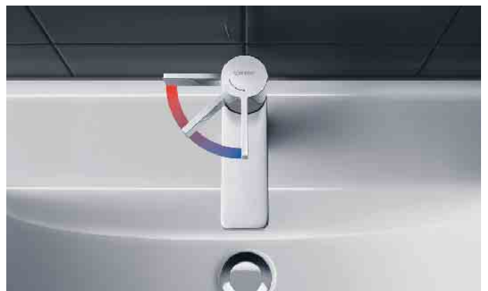
Die energiesparende FreshStart-Funktion bei Einhebelmischern sorgt dafür, dass die Beimischung von Heißwasser erst erfolgt, wenn der Hebel bewusst nach links bewegt wird. Foto: Duravit/FreshStart/akz-o
